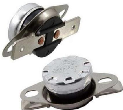
Термостат RUICHI KSD-50, 50 °С, 10 А, SPST NC - это контакт, который при нагреве свыше температуры определенной температуры размыкает электрическую цепь. Они используются в конструкции различных электроприборов, предполагающих нагрев, таких как водонагреватели (бойлеры), электроплиты, духовые шкафы, электро котлы, обогреватели, микроволновки, стиральные машины.
